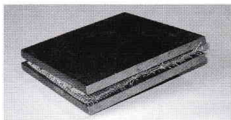
2 | Eine selbst gebaute Ölpress (Die beiden Metallplatten werden durch die Backen eines Schraubstocks aneinander gepresst.)
